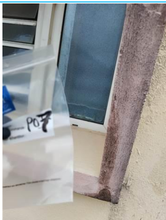
Matériaux : Z26 - Façades extérieures - Embrasure fenêtre - enduit + peinture Prélèvement : P007 Description : enduit + peinture Localisation : Bâtiment 009 - Façades extérieures - Sud - Embrasure Résultat : Présence d'amiante
